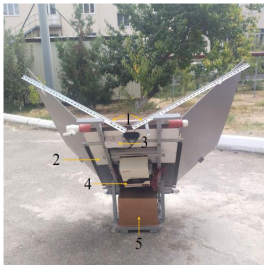
2-rasm. Kristalli kremniy asosidagi avtonom ko‘chma fotoissiqlik qurilmaning orqa ko‘rinishi. 1-reflektorni tutib turuvchi tirkama. 2-sovutish kollektori. 3-istemolchi ulanadigan qism. 4-invertor. 5-akkumulyator
